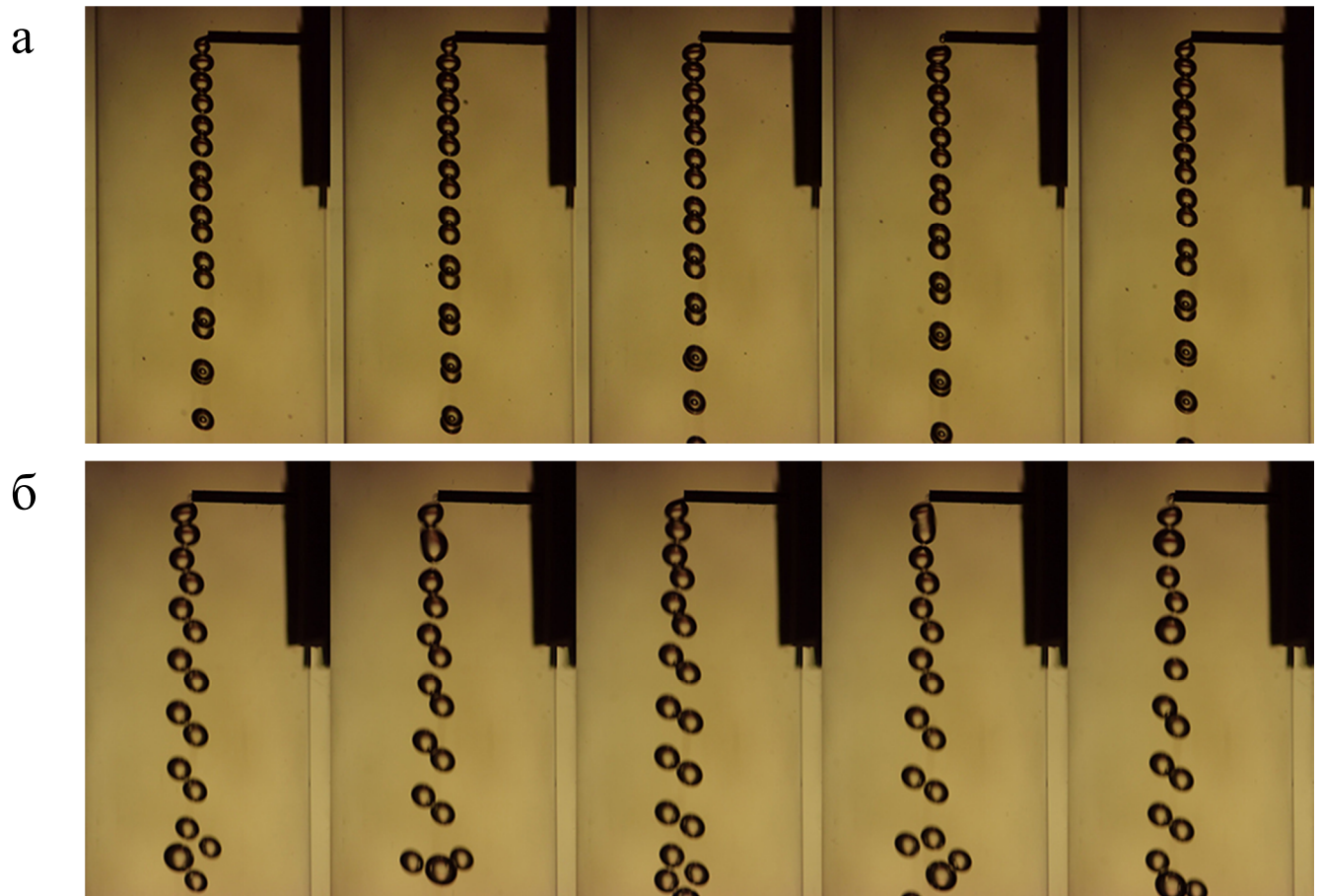
Рисунок 3.24. Последовательности кадров соответствующие режимам течения с двумя пузырьковыми струями. а – течение с параметрами d_o = 0.5 мм, T = 80^\circ\text{C} , U_L = 0.25 м/с, Q_g = 17 мл/мин; б - течение с параметрами d_o = 0.5 мм, T = 70^\circ\text{C} , U_L = 0.19 м/с, Q_g = 17 мл/мин.
